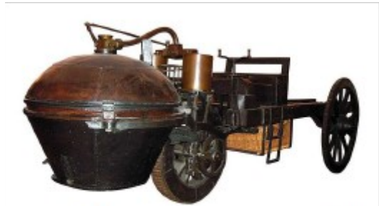
Automóvil de vapor de Cugnot, versión de 1771.
